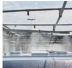
Dichtigkeitsprüfung auf Wassereintrich bei 100% der produzierten Fahrzeuge, vor der Auslieferung.
