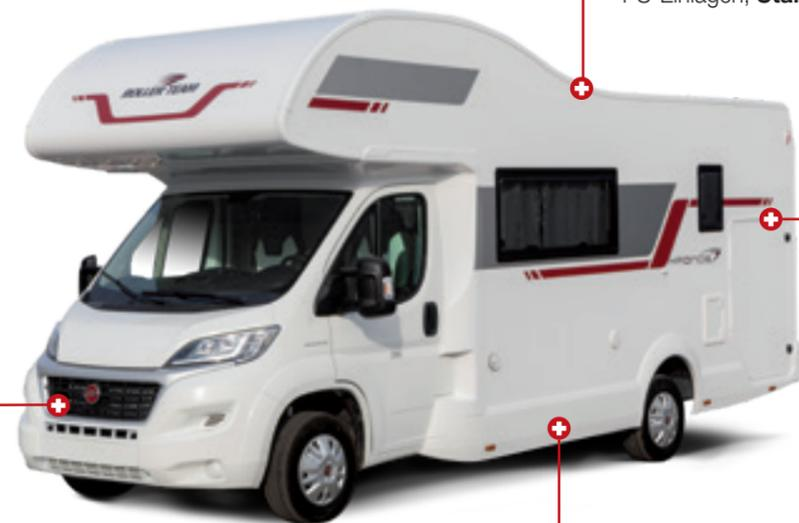
**Seitenwände** aus Glasfaserkunststoff innen und außen, extrudierter Kunststoff in den Wänden, **Stärke 31 mm.**
